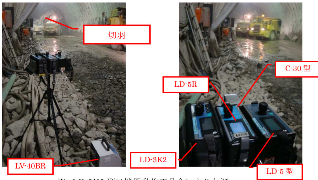
図 2 切羽左側、ずり積みおよび吹き付け作業時の粉じん濃度測定状況
