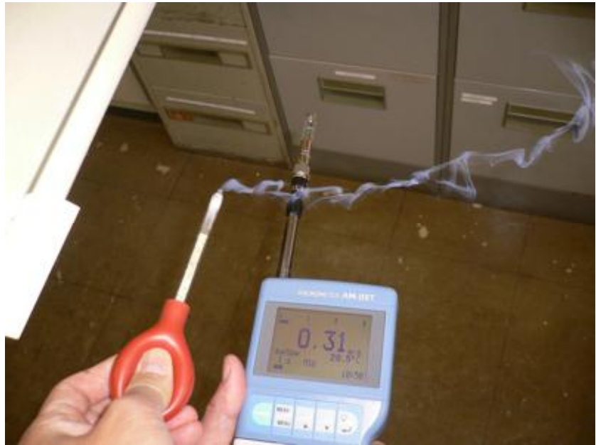
写真：風速測定と同時にスモークテスターにより風向も確認
