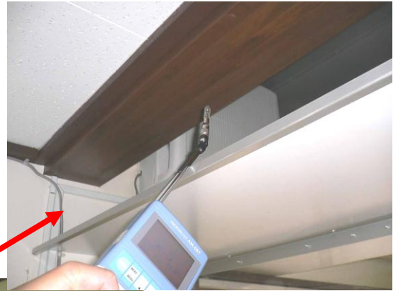
排気口における 風速測定
