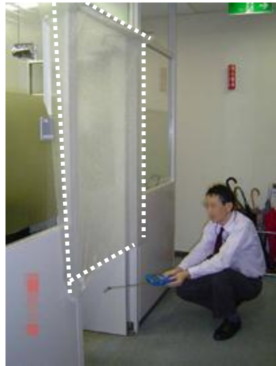
正しい風速測定方法 (開口部分の一定方向の気流を測定。 排気風量が 990\text{m}^3/\text{h} しかないため、漏れ防止対策として出入口に床上 60\text{cm} のスクリーンをかけ、開口部分の気流を 0.2\text{m/s} 以上に強化した事例)
