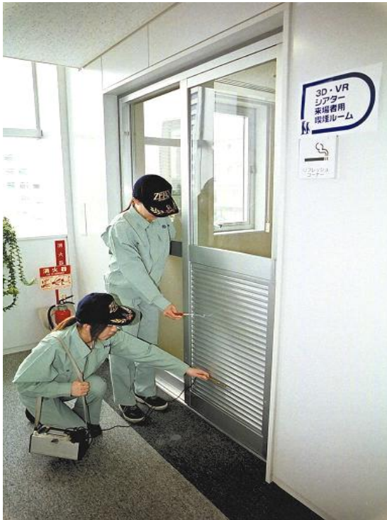
誤った風速測定方法 (ガラリ部分の気流を測定)
