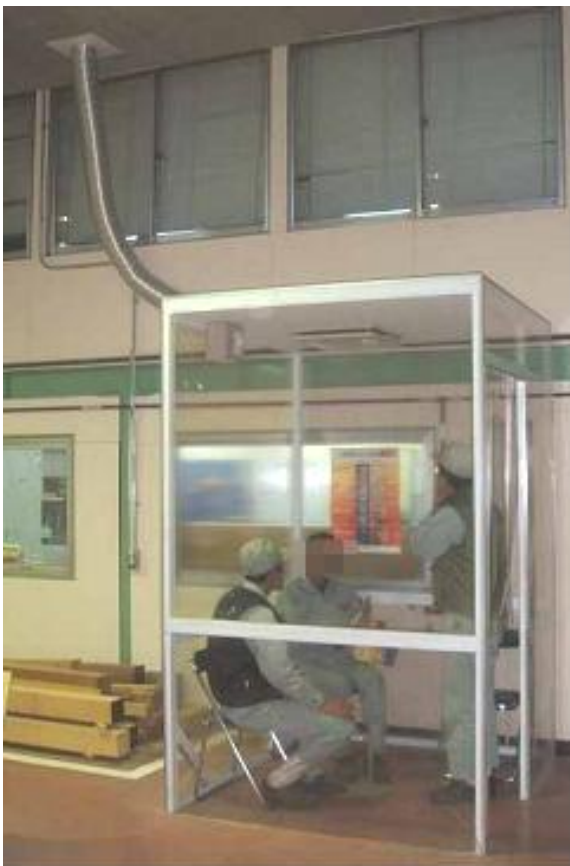
建築で使用される安価な部材を利用して箱を作成
