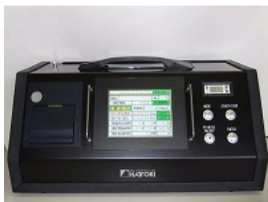
図-23 繊維状粒子自動測定機の例
