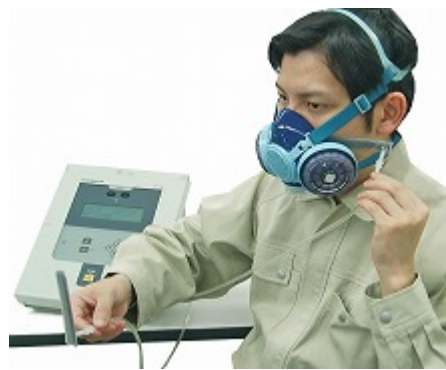
図-15 マスクフィッティングテスター使用例
