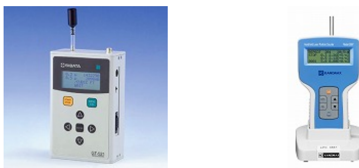
図-20 パーティクルカウンターの例
