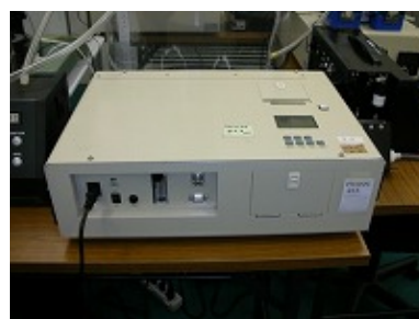
図-23 繊維状粒子自動測定機の例
