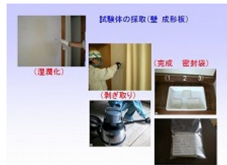
図-5 サンプルング例 (成形板)
