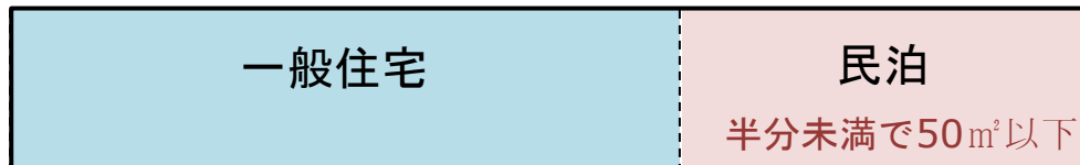
図1 民泊部分が建物全体の半分未満で50㎡以下である場合 ⇒ 建物全体が 一般住宅 として取り扱われる
