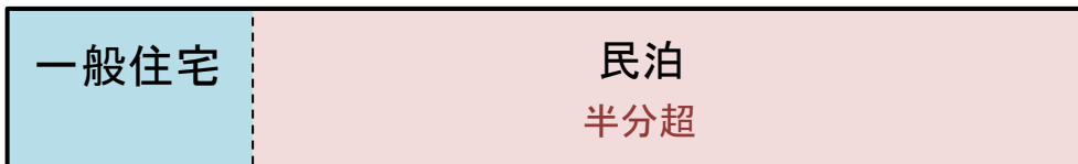
図3 民泊部分が建物全体の半分よりも大きい場合 ⇒ 建物全体が 宿泊施設 として取り扱われる
