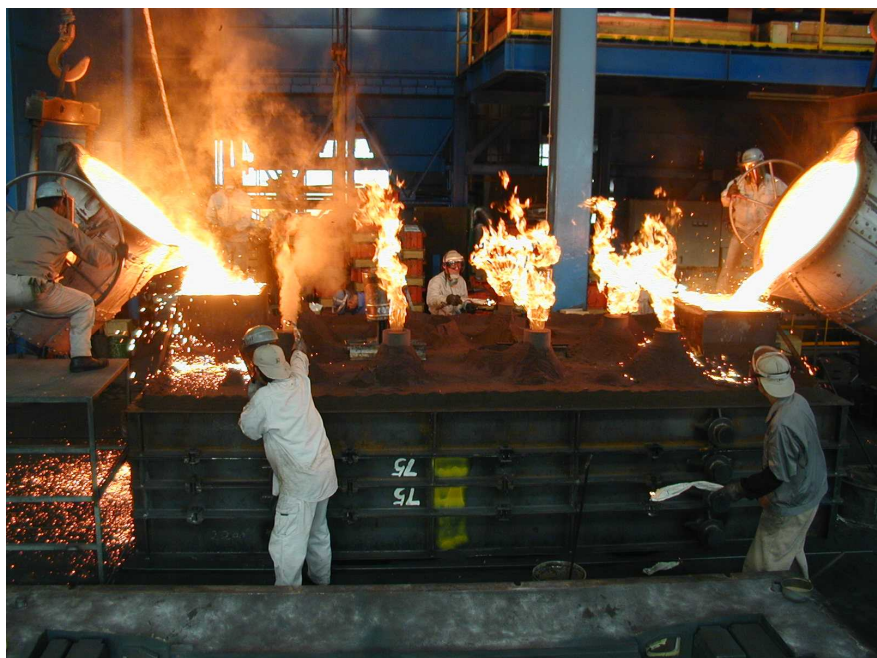
液晶露光装置用鋳物の鋳造作業
