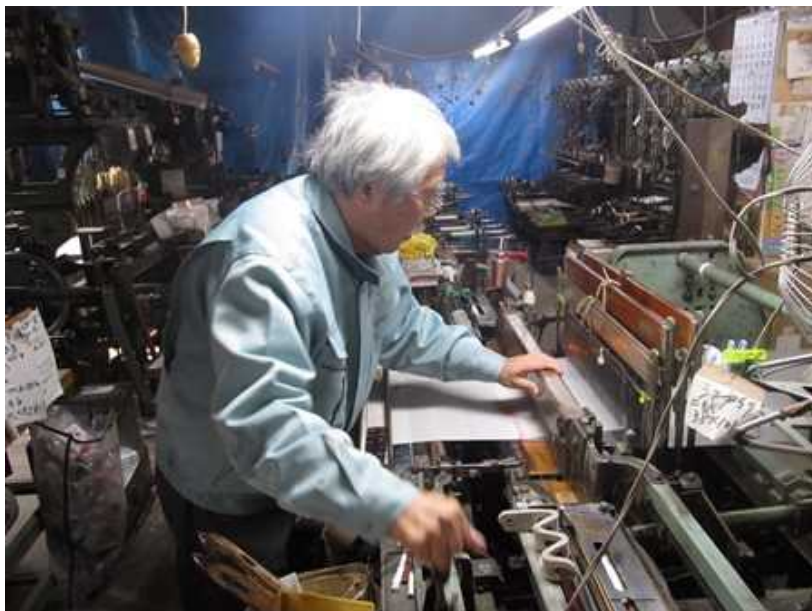
製織（せいしょく）…経糸に強い撚りを掛けた緯糸を織り込む工程
