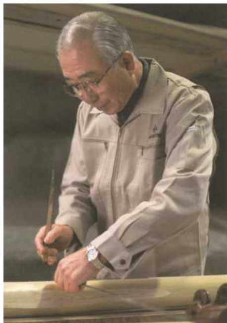
自然の丸太材に基準となる墨線を打つ「墨付け」
