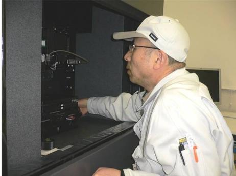
測定針先端部研削作業
