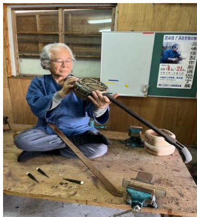
[蛇皮太鼓と棹を接合後の高低調整作業(分当て)]
