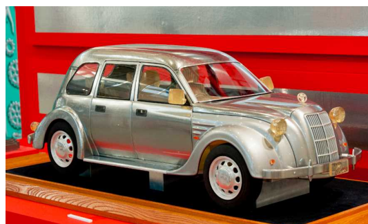
[板金手加工で製作した (トヨタ・AA型乗用車1/5モデルとグローブ)]
