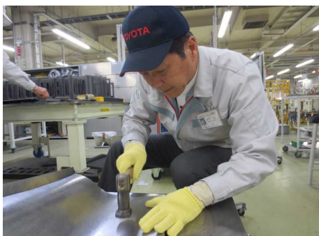
[ボデー外板部品の製作風景 (左: 打出し板金作業、右: 平滑度確認)]
