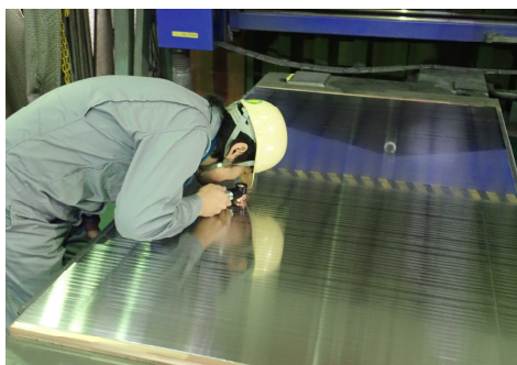
[連続鋳造用鋳型のめっき仕上がり状態の確認]
