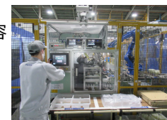
▲産業用ロボットを使用した部品検査設備の立上げをする岡さん
