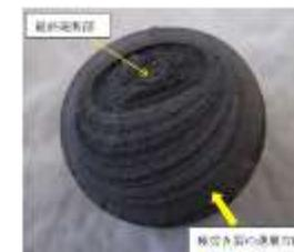
疲労破壊で破断したボルト破断面
