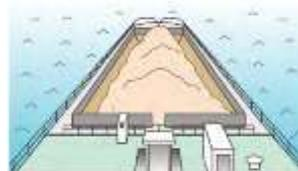
土砂運搬船のイメージ
