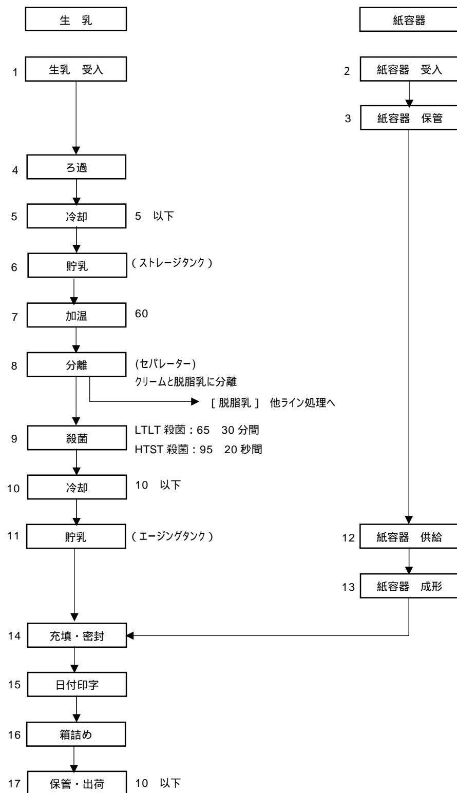
上記製造工程図は一例です。工程図を作成する場合は、各事業者の実工程、工程条件に合わせてください。
