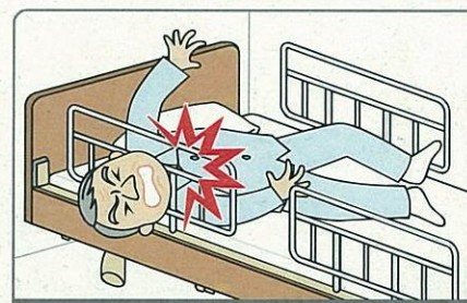
サイドレール内のすき間
