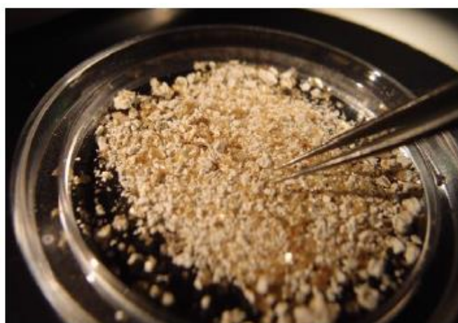
図 3.54 アスベスト繊維をピンセットで取り出す
