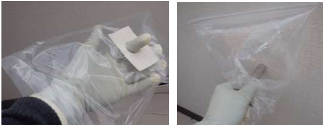
写真左：チャック付き袋に両面テープを貼り、穴を開けた簡易グローブバッグ 写真右：簡易グローブバッグによる試料採取
