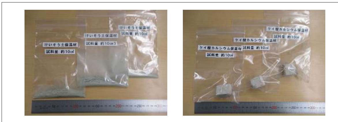
図 3.17 3箇所から採取した試料を袋に収納した例
