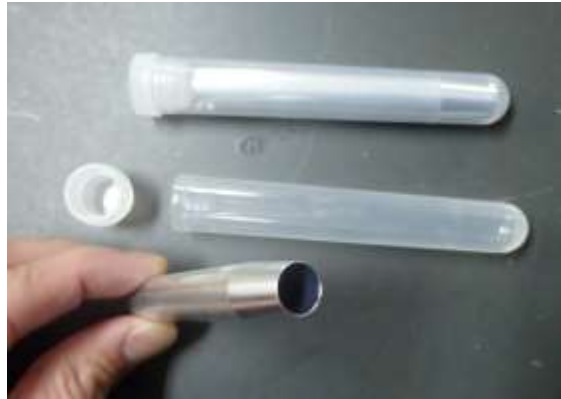
写真左：コルクボーラーは、筒状の先端がギザギザになっており、回転させて採取する。 写真右：採取用チューブ（輸入品）は、筒状の先端が鋭くなっており、差し込んで採取する。
