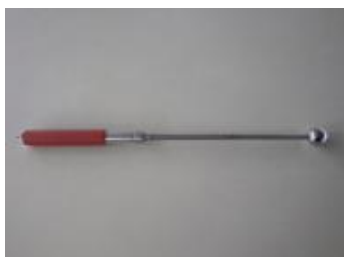
打診棒(異種材料や空洞、充填などがわかるが経験を要する)
