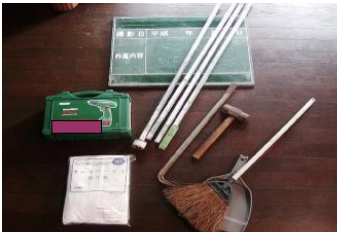
図 3.3 調査用品の例（改修や解体の事前調査における用品の例）
