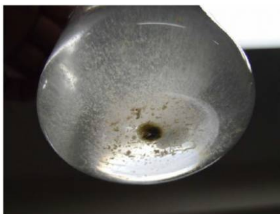
図 3.49 回転させるように攪拌すると底部に骨材のような重い成分が集まる
