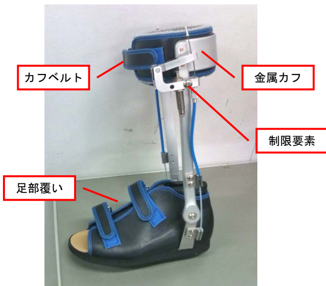
図3. 背屈制御のユニットが見える外観 足関節の下にインナーワイヤー、上にインナーワイヤーが通るアウターワイヤーが配置される。足関節にかかる力と角度の変化により固定されたアウターワイヤーの中からインナー
