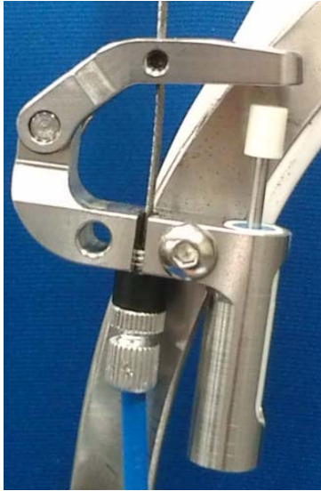
図12. 2.5次試作の制御ユニットベース
