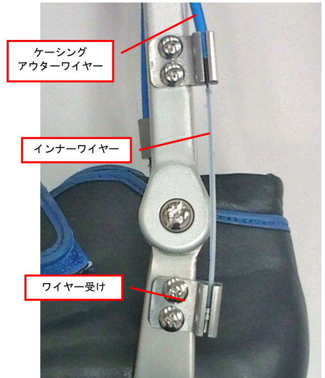
図4. 背屈制御ユニットの詳細
