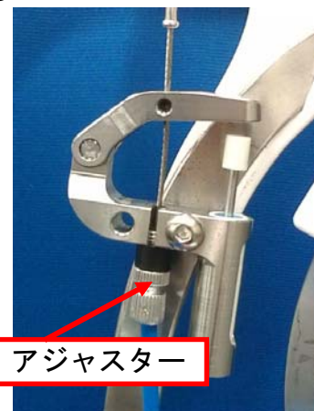
図5 手綱機構の制御ユニットとアジャスター
