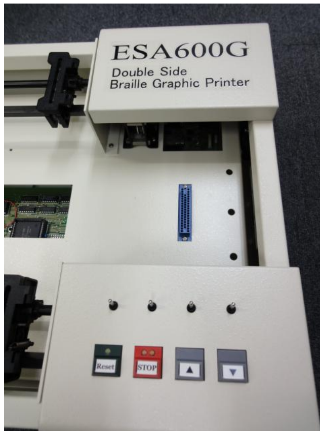
図E-4 プロトタイプ2号機(操作スイッチ・印字ボックスとのコネクタ)
