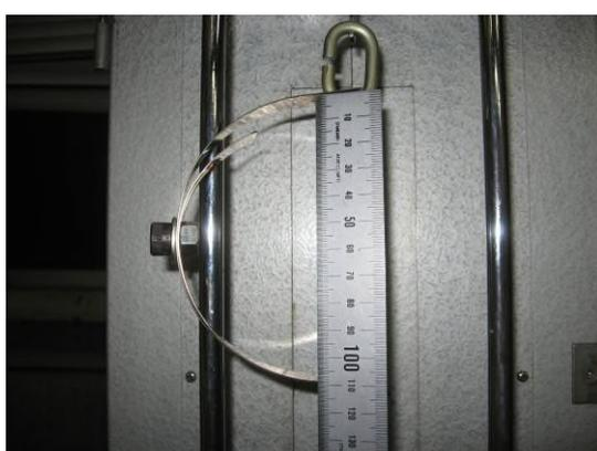
写真34 試験中（変形量+20mm）
