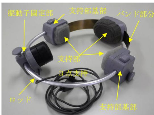
写真35 試作した固定バンド
