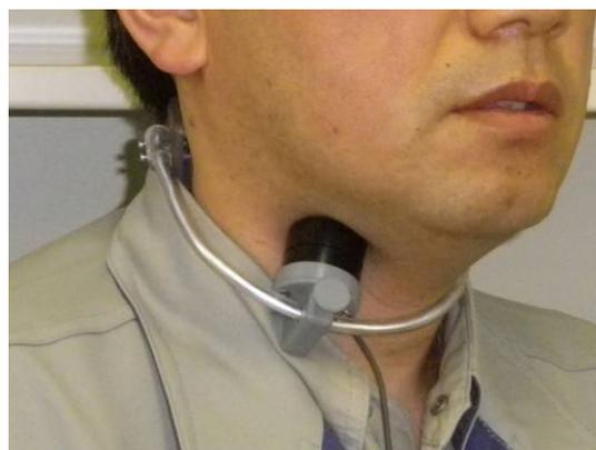
写真53 再試作固定バンド装着状態1
