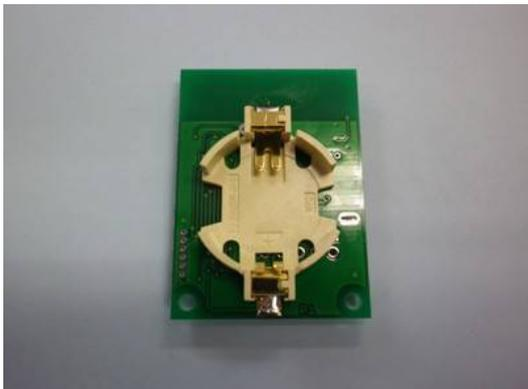
写真1 4 送信基板電池挿入部
