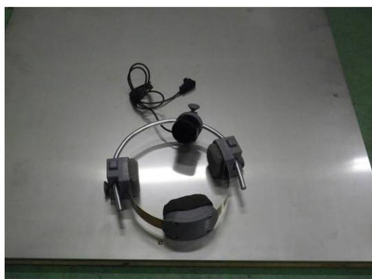
写真 6 3 自然落下試験後 固定バンド
