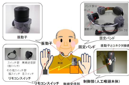
図1 試作装置全体システム図
