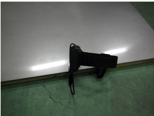
写真 6 5 自然落下試験後 リモコンスイッチ
