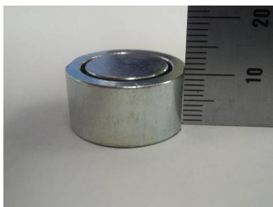
写真2 従来型磁気回路寸法
