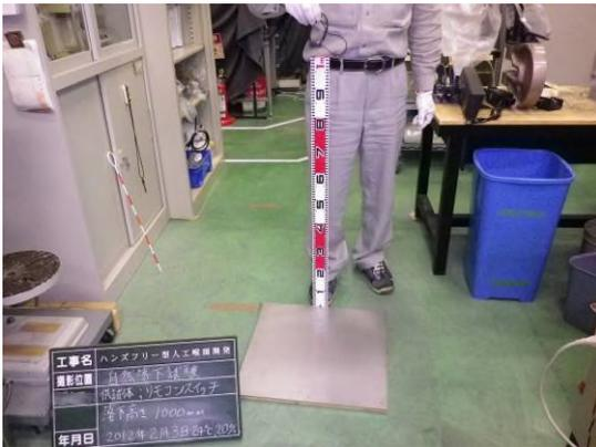
写真 6 4 自然落下試験状況 リモコンスイッチ
