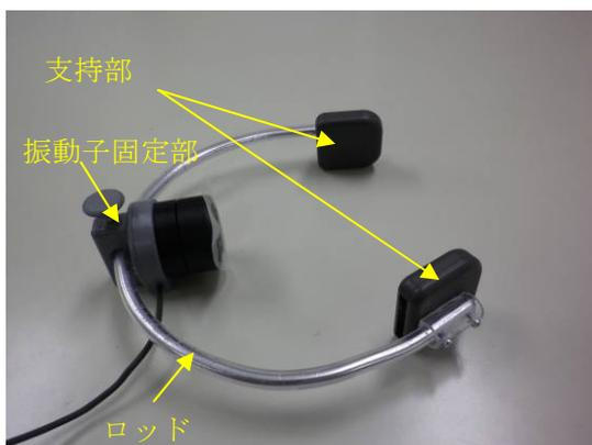
写真51 再試作した固定バンド
