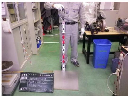
写真 6 2 自然落下試験状況 固定バンド
