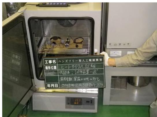
写真 6 6 温度環境試験状況
