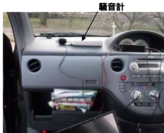
写真 7c 騒音計を車内に置き、窓の開閉により騒音の大きさ（レベル）の違いを測定
