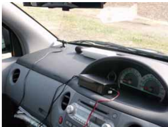
写真 8a 車内のマイクと騒音計の配置
