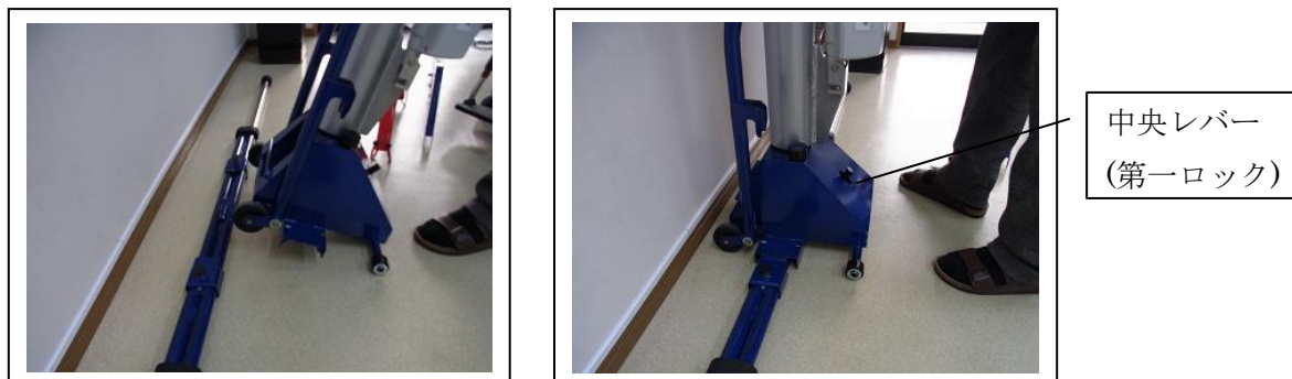
図 2-1 安定脚部と支柱の接合
