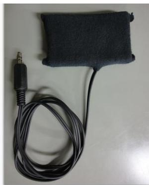
図6 改良型筋収縮センサ
