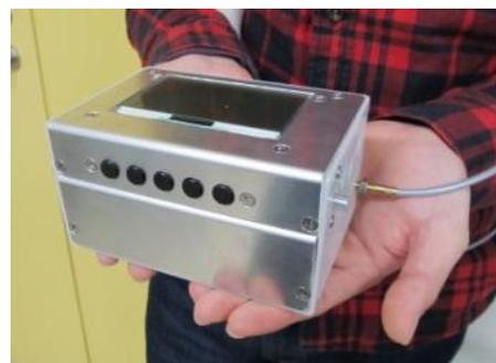
図 5 試作したコントローラ
