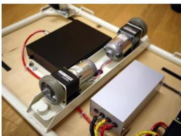
図3 第2次試作機の駆動部分
