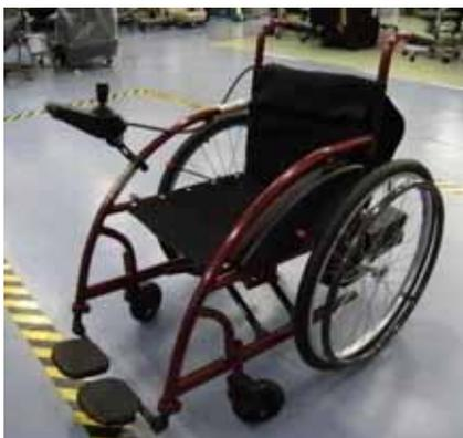
図1：簡易形電動車いす 2次試作
