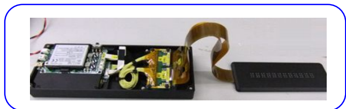
図2.2 点字デバイス2nd試作機(全体構成)
