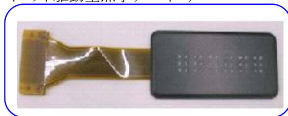
図3. ダイレクト駆動型点字デバイス
