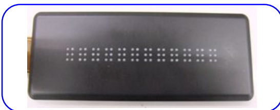
図2.1 点字デバイス2nd試作機(12文字)
