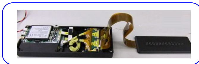
図2.2 点字デバイス2nd試作機(全体構成)
