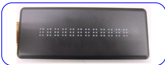
図2.1 点字デバイス2nd試作機(12文字)
