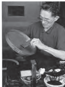
図 6-2-4 塗り師による漆塗り作業
