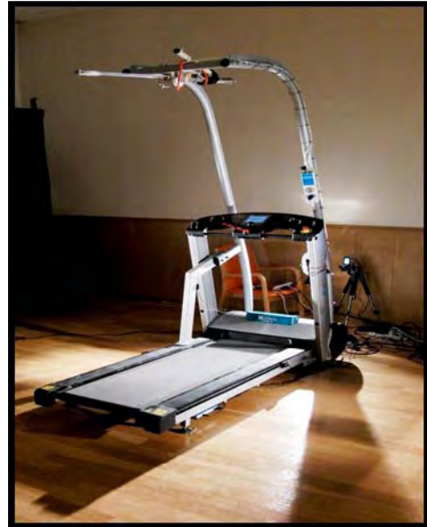
図 7 Zebris FDM-T (足圧センサー付きトレッドミル)
