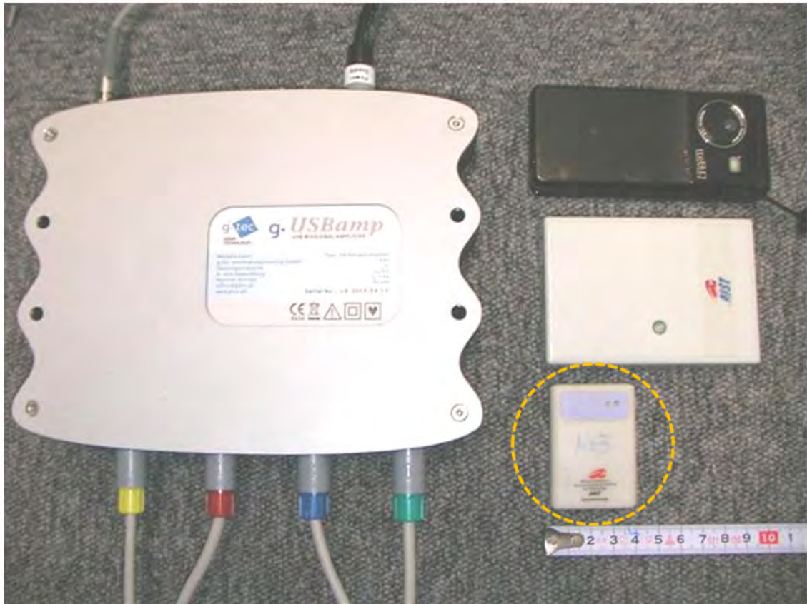
図 6 超小型8ch無線脳波計（右下）。左：市販の有線脳波計。右上：一般的な携帯電話。右中：前回の試作の4ch版無線脳波計。
