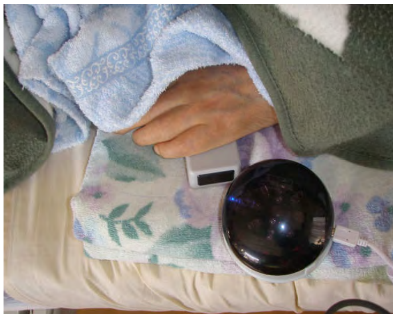
図 26 バイブレータの設置例
