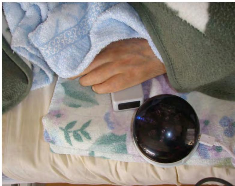
図 26 バイブレータの設置例
