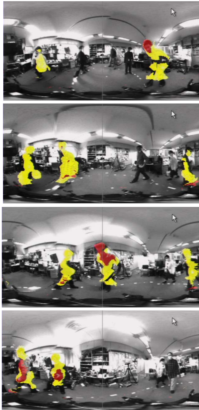
図 C-4-14 全方向距離情報を用いた電動車いす周囲の人物検出の例：電動車いすを走行させながら周囲の人物を検出している。電動車いすから 1.2 m 以内に近づいた部分を黄色、50cm 以内に近づいた部分を赤で表示している（1.2m より遠いものは人物であっても色をつけず、そのまま表示している）。画面はメルカトル図法に基づいたパノラマ画像で、画像の中央が電動車いすの前方、画像の左右端は実際にはつながっていて電動車いすの後方を示す。
