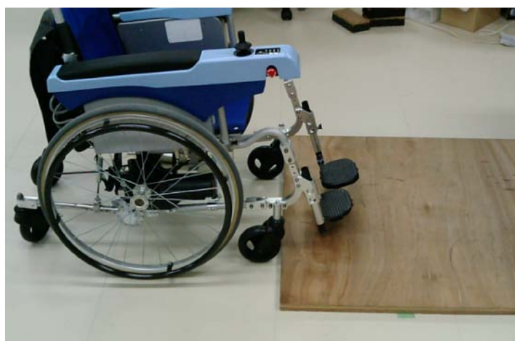
図 C-2-9 段差に接触した状態
