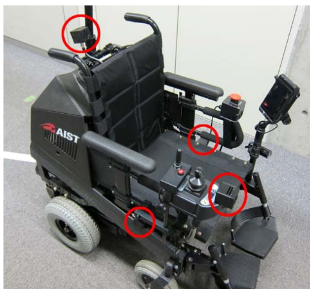
図 C-4-9 近赤外光投光器の設置位置
