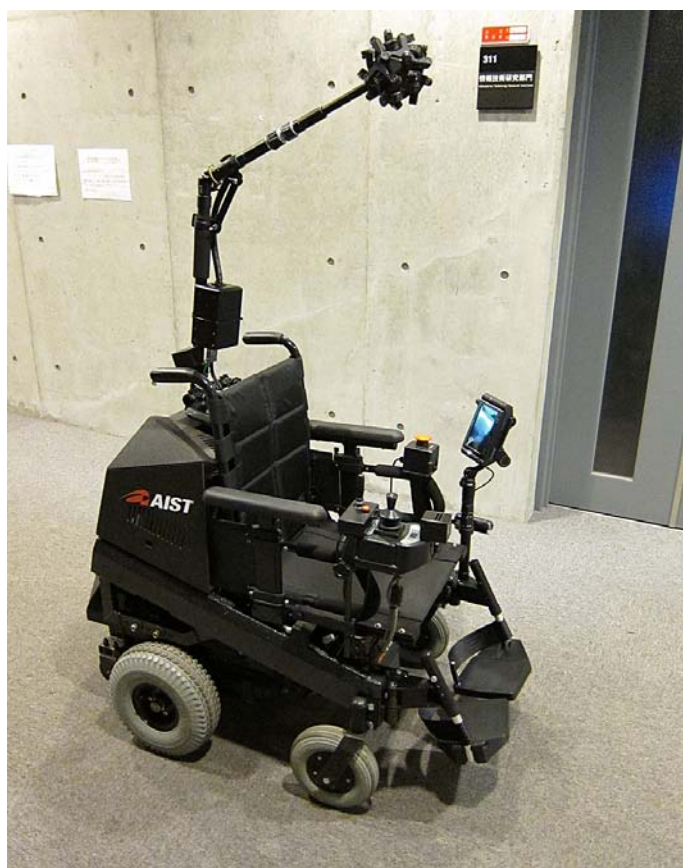
図 C-4-8 全方向ステレオカメラを搭載した電動車いすの外観
