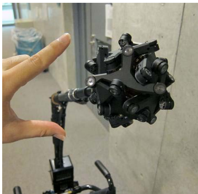
図 C-4-1 開発した暗視対応全方向ステレオカメラの外観
