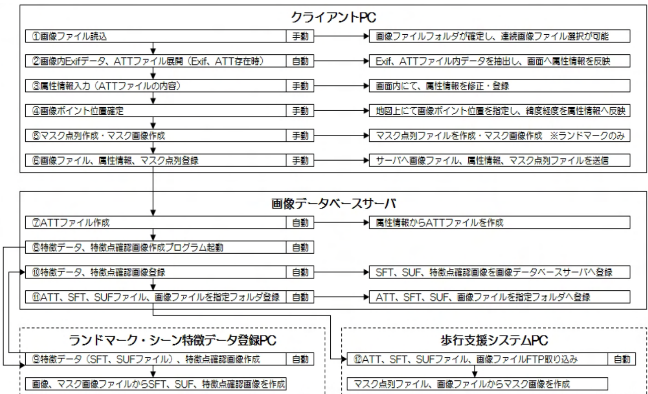
図 II.5-2 画像 DB への画像登録時の処理フロー
