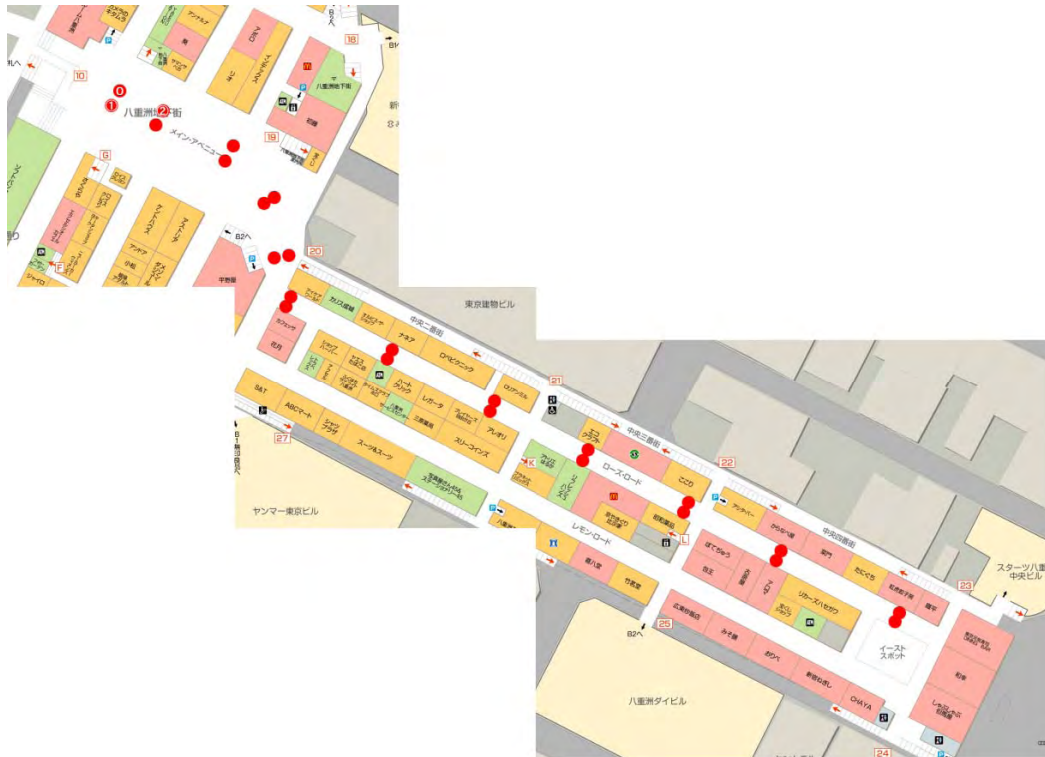
図 II.5.-12 RFID タグの配置図 (八重洲地下街)
