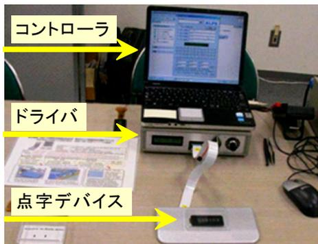
図11.2 点字デバイス試作1号機の全体構成
