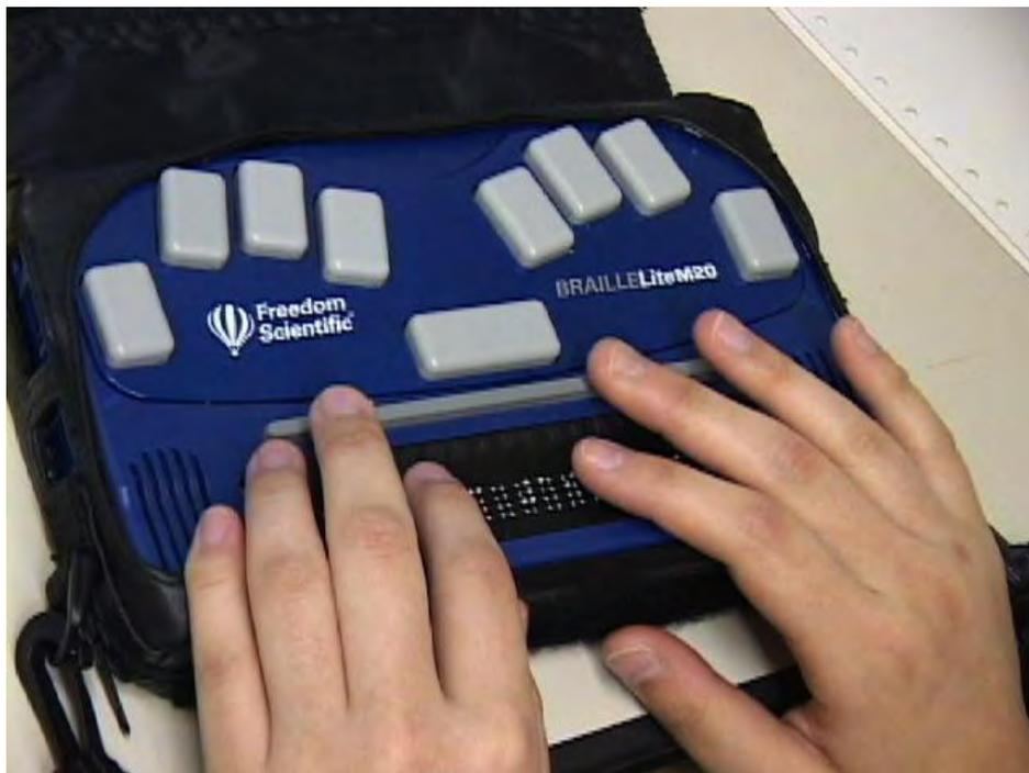
図7 携帯型点字情報端末の点字ピンディスプレイ
