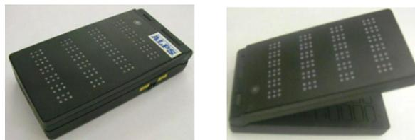
図13.0 点字デバイス試作2号機
