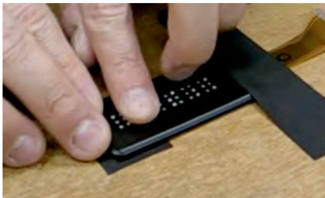
カーボンナノチューブ高分子アクチュエーターを用いた薄くて軽いフィルム状の点字ディスプレイ
