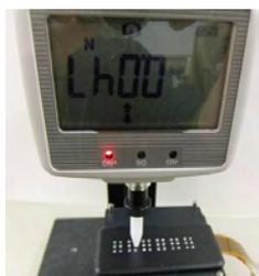
図1 点字デバイス発生荷重測定
