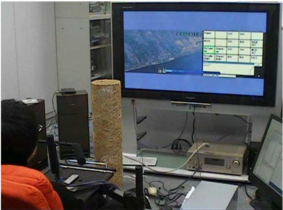
図 II-2-8 発声を伴った頭部ジェスチャ認識を用いた操作インターフェース
