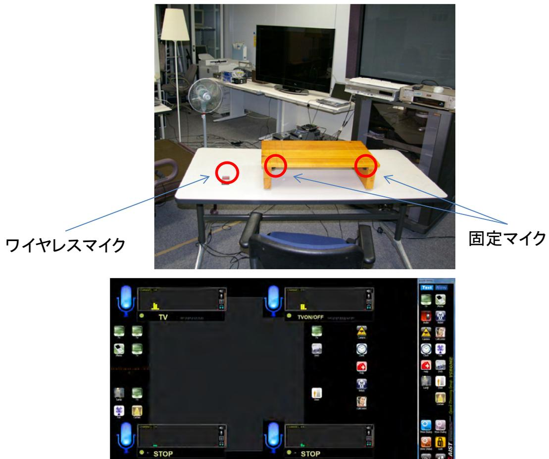
図I-6 音声認識装置外観および操作画面
