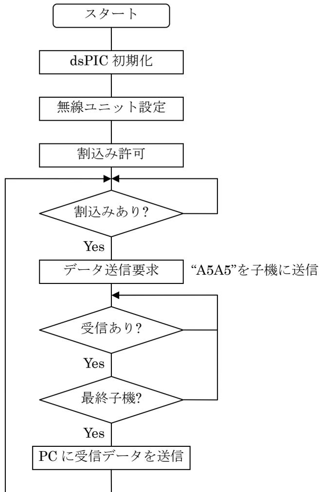
図 II-4-6 センサー親機におけるセンサーデータ処理のフローチャート
