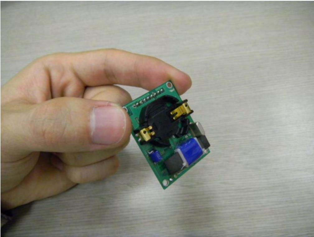
図I-11 電波強度により3次元位置を計測する無線タグ
