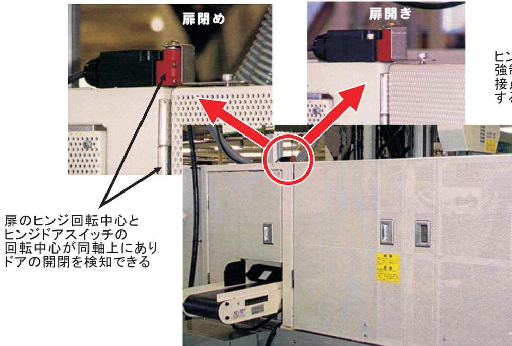
ヒンジドアスイッチの接点部は、強制接点開離機構を有しており、接点溶着によるトラブルを回避することが可能である。
