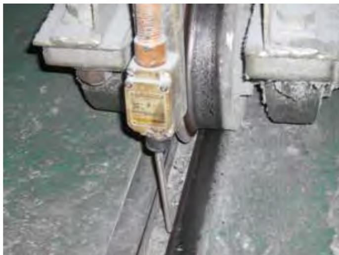
写真 2 トラバース (台車) のリミッター
