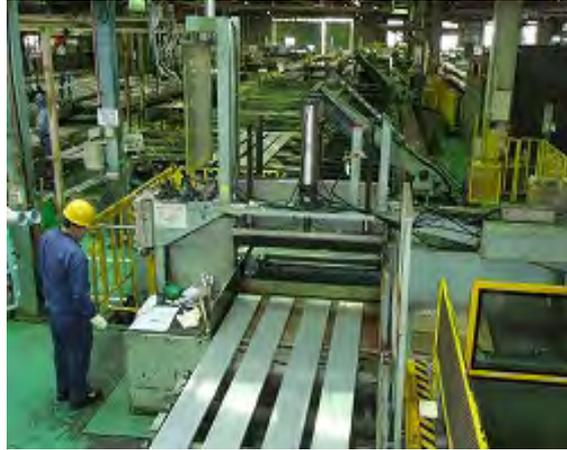
⑥ 後面設備（製品切断機-2）
