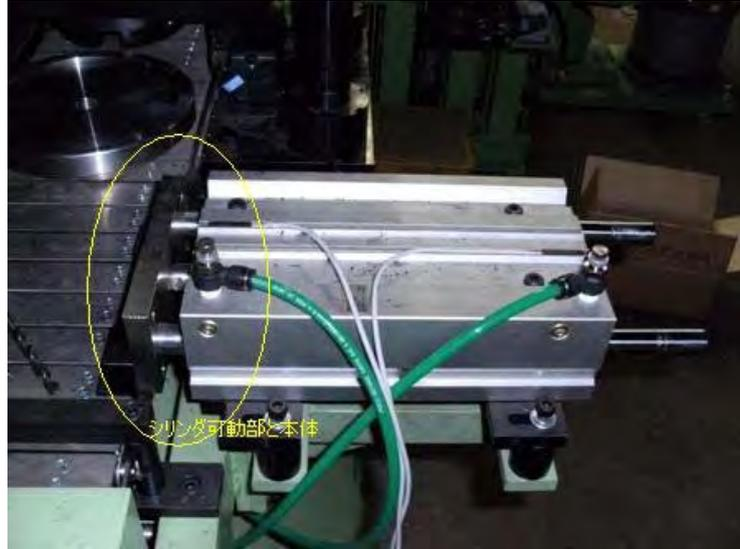
写真 3 金型押出機構
