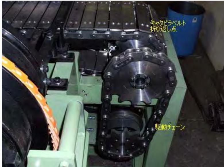
写真5 キャタピラベルトコンベア駆動部
