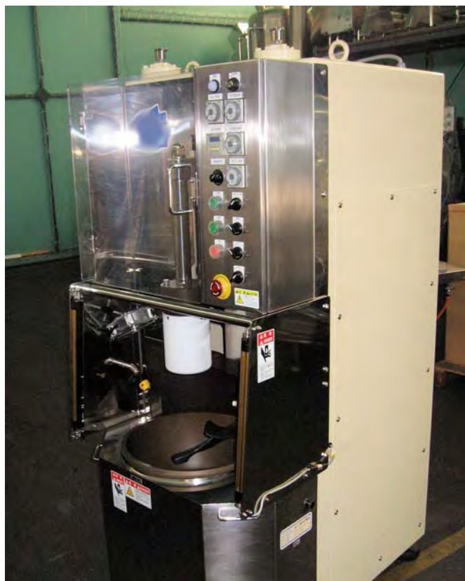
写真 3 杵駆動のための開口部へのアクセスを防止するインターロック付き可動式ガード
