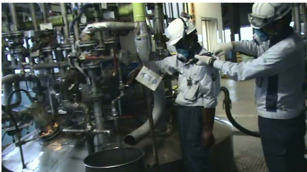
写真1 リスクアセスメント対象作業、DMFをオープン容器に充填する作業
