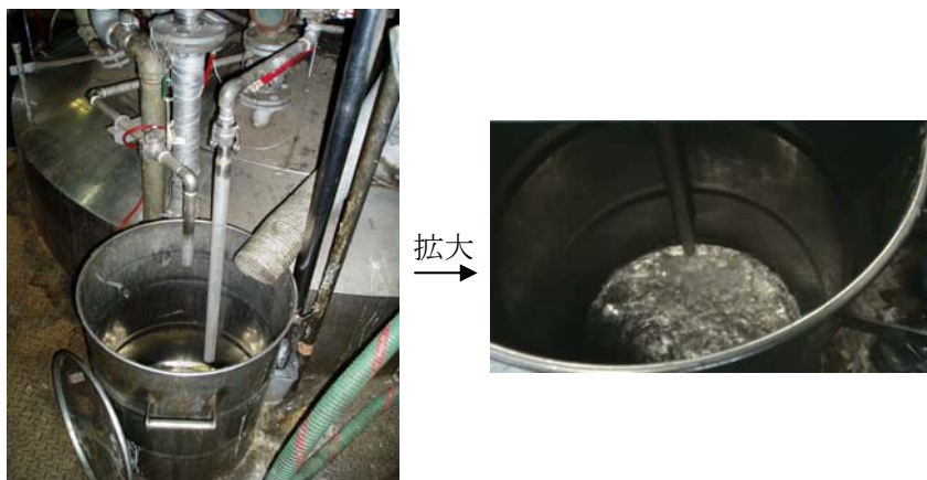
写真 3、4 DMF 充填位置の変更 液中パイプ経由・容器底部から充填
