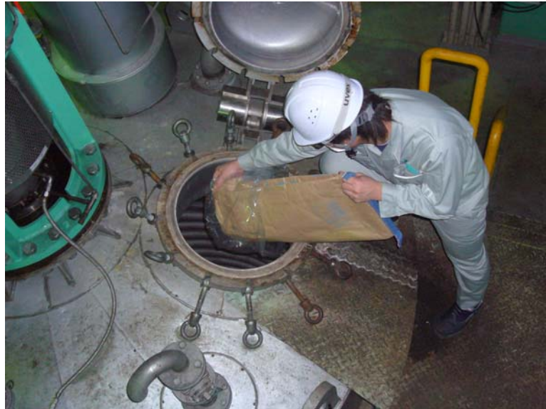
内容物の溶剤等を攪拌しながら、反応缶に粉体原料を投入する工程
