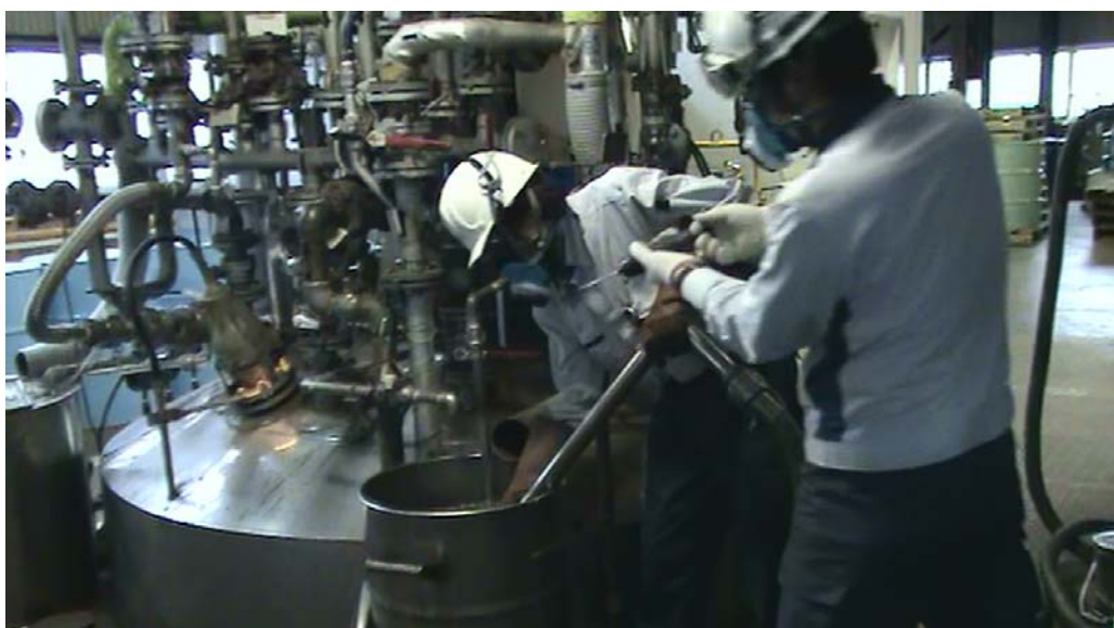
写真2 リスクアセスメント対象作業 ステンレスノズルを洗浄する作業
