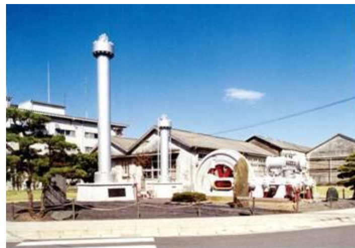
国内で初めてアンモニアを生産したカザレ式合成装置
