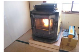
足寄町公共施設(旧職員住宅)にて ペレットストーブを燃焼実験中
