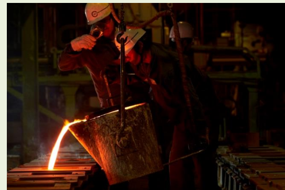
写真：製造工程(注湯)
