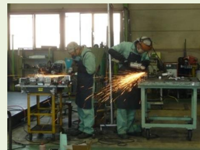
写真:溶接後グラインダー仕上げ作業
