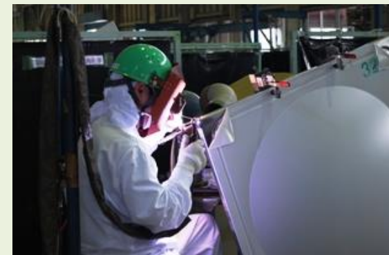
写真:OJT(実習)の実施風景(ステンレスパネルタンクの溶接)
